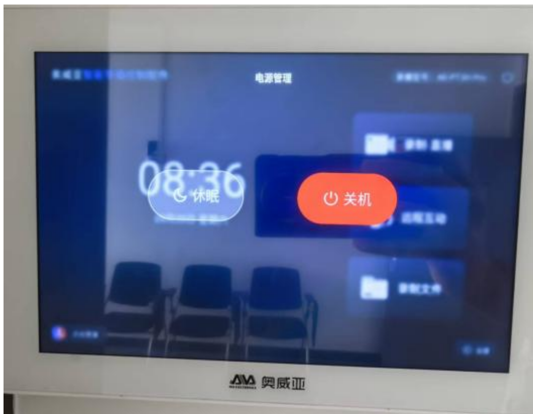
6.2 弹出按钮点击关机, 关闭一体机, 关灯, 空调
